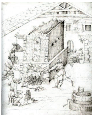
Figure 1: 16th century kiln as illustrated by Piccolpasso in Li Tre Libri dell'Arte del Vasaio
