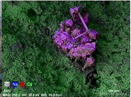
Figura 1b- Análise EDS ao verso do vidrado onde se vê um aglomerado de cristais cúbicos de cloreto de sódio.
