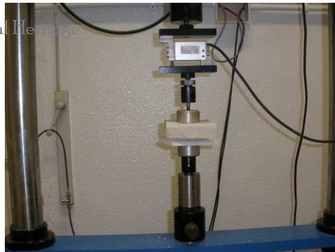
Figura 3 - Provete ensaiado à tensão de aderência
